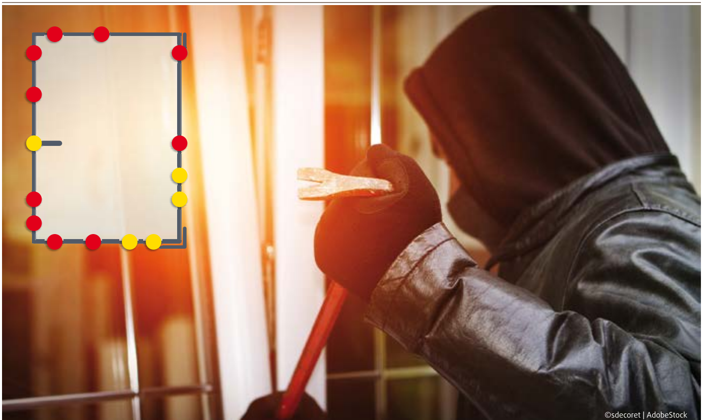
Abb. zeigt Beispiel für Fensterelement 1300 x 1500 mm | ● Sicherheitsschließsteile ● gegenläufige Verriegelung und selbsthemmendes Getriebe
